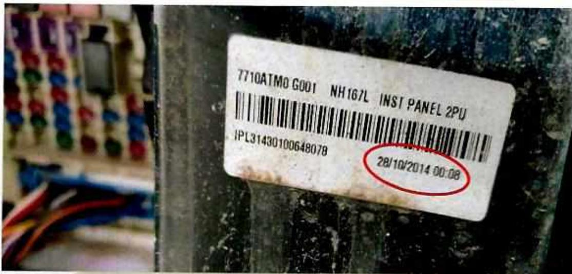
**Sticker pegada debajo del tablero electrónico en la cual se visualiza el año de fabricación del automotor.**
