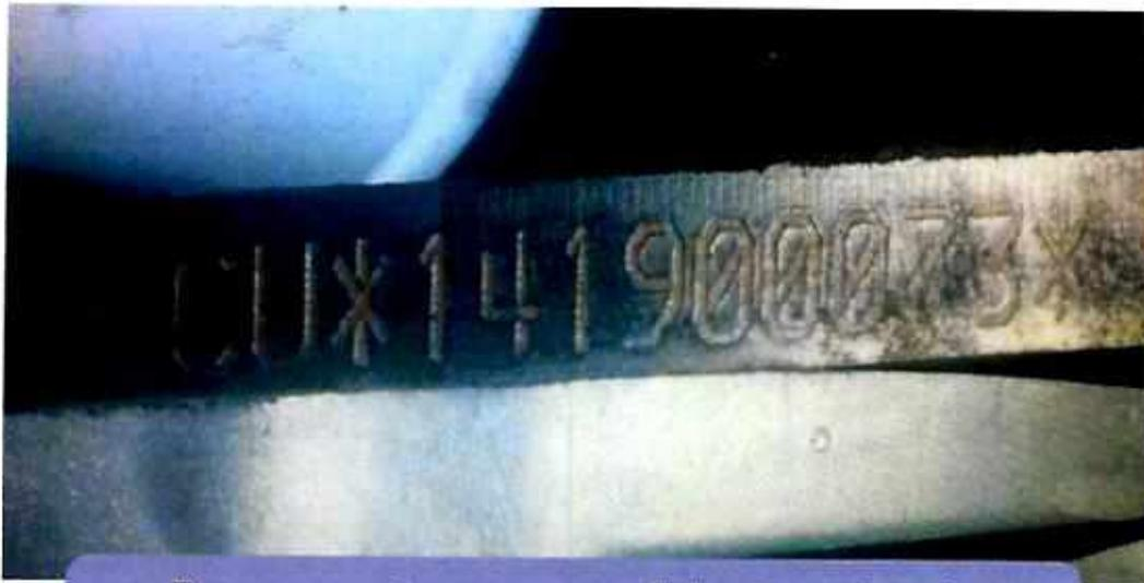
**Bases soportes con superficies fresadas sin defectos de preparación y guarismos por "rayado"**
