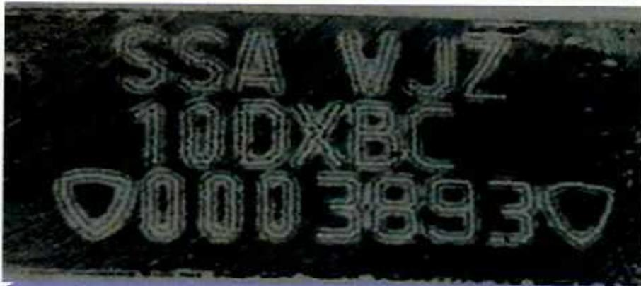
**Base soporte con superficies fresadas sin defectos de preparación y Guarismos por "rayado"**
